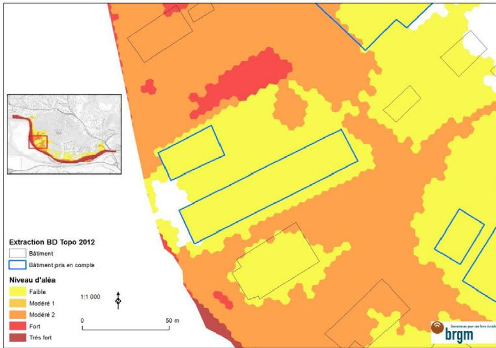
Figure 52 : Intégration dans la surface de submersion les surfaces isolées de moins de 50 m<sup>2</sup>.
