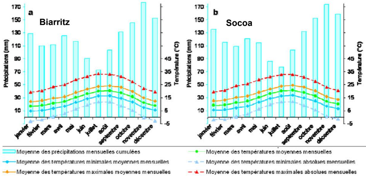
Figure 9 : Diagrammes ombrothermiques.
